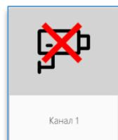
Перечёркнутая камера означает, что данный канал отключён. Перед включением требуется его настроить.
