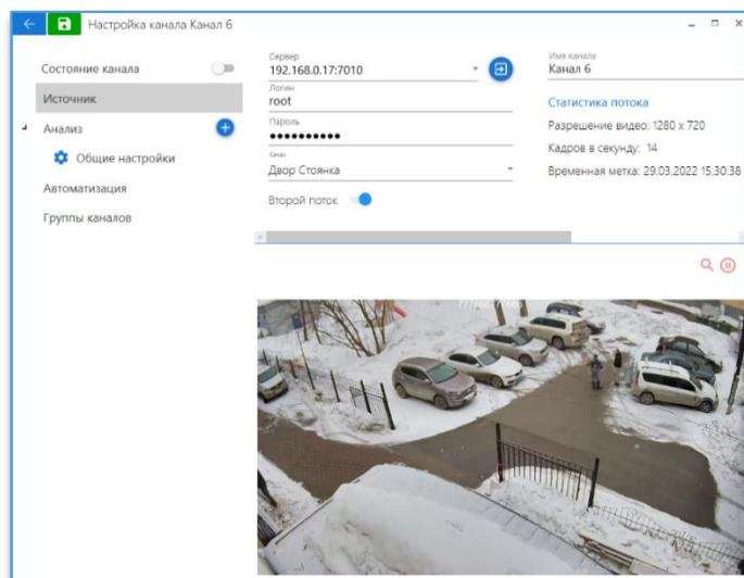
Чтобы включить канал, нужно задействовать соответствующий тумблер в «Состояние канала».
