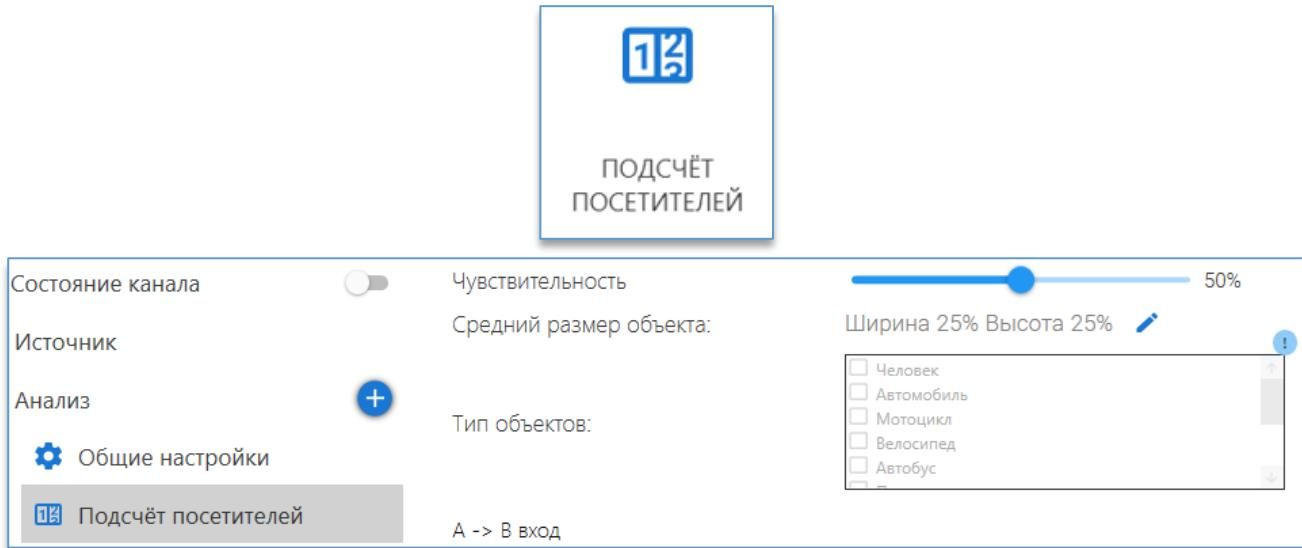
После добавления модуля подсчёта посетителей на изображении с камерой отобразится линия с указанием направления входа. Линию можно перемещать и менять её размер. Объект будет подсчитан, если пересечет линию по направлению «A -> B» и исчезнет из поля зрения камеры.
