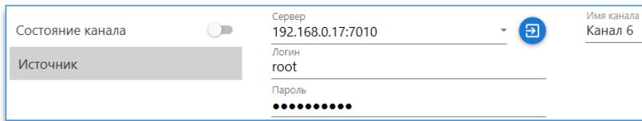
Кнопка используется для подключения сервера после ввода верных данных.
