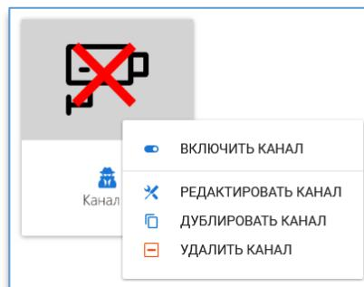
При зажатии клавиши Ctrl или Shift доступно выделение каналов левой кнопкой мыши с целью их одновременного включения, отключения, дублирования и удаления.
