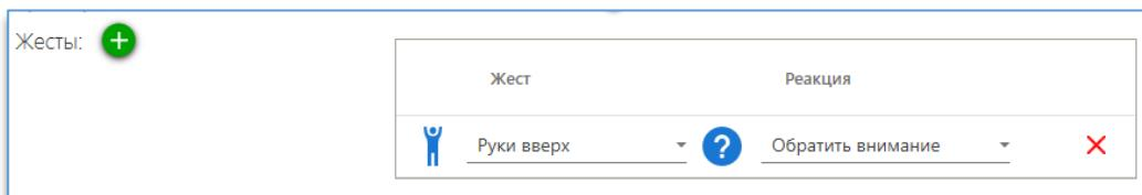
Для одного детектора допускается задавать до 5 различных типов жестов, на них могут быть назначены разные или одинаковые реакции.
