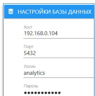
Чтобы разрешить подключение к базе SQL сервера аналитики, необходимо на компьютере, где установлена служба, в директории «C:\Program Files\PostgreSQL\10\data» открыть файл «pg\_hba.conf» с помощью любого текстового редактора, найти строку «IPv4 local connections» и прописать правило для подключения.
