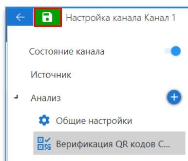
Чтобы включить работу модуля, нужно выйти из редактирования канала, нажав на кнопку «Назад»
